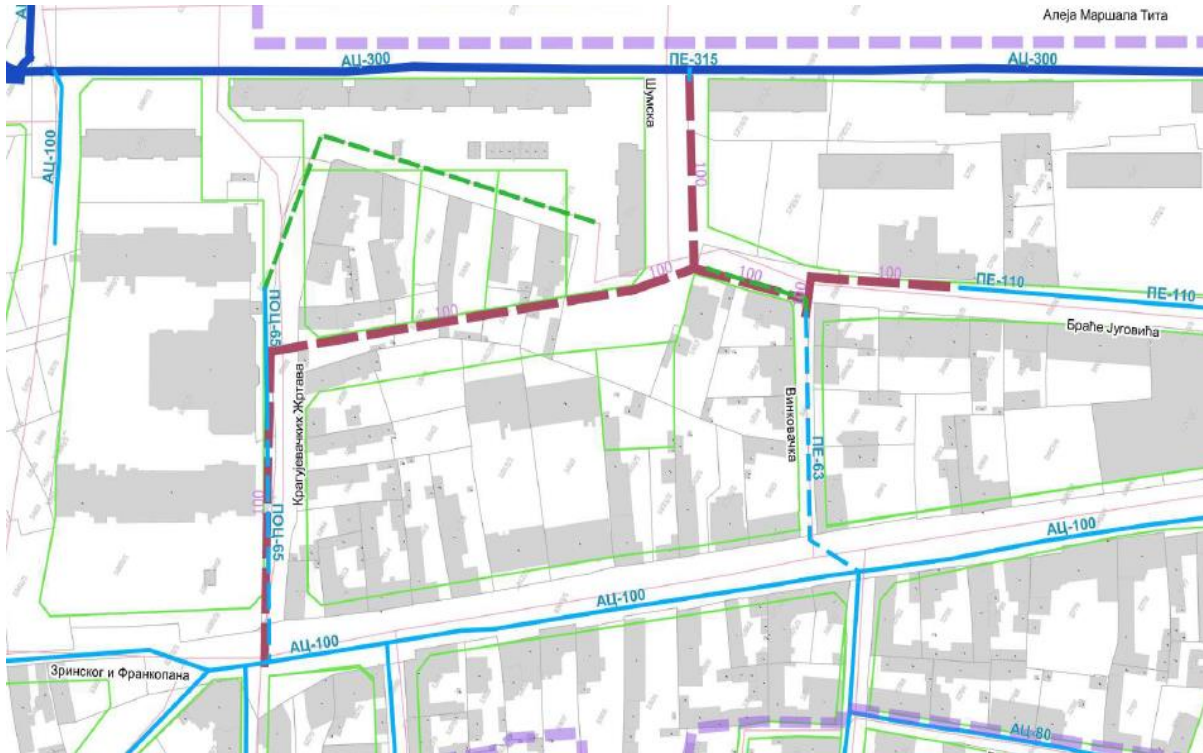
1. ábra – Kivonat a I2-216/2022 sz. feltételekből–2. melléklet; sötétkék vonalak – gerincvezeték, világoskék vonalak – elosztó vezeték sötétzöld vonalak – csoportos csatlakozások barna vonal – a 100 mm átmérőjű hiányzó elosztó vezeték gyűrűbe kötve
